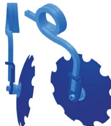
Amortiguador de brazo caracol de 35x35 mm, utilizado en grada de disco U 652
